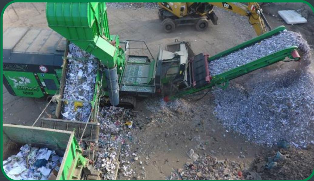
Planta completa móvil para la trituración y molienda de residuos industriales y urbanos con la trituradora HAAS TYRON 2000 XL v.2.0 y el molino de martillos HAAS ARTHOS 1600.
