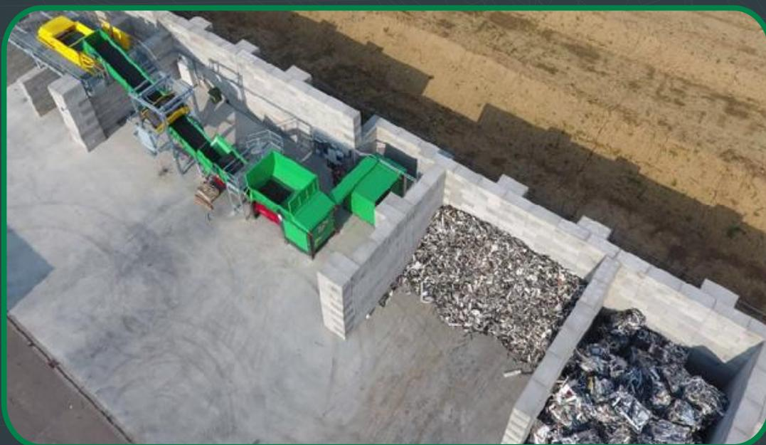
La **planta de reciclaje estática y eléctrica** está compuesta principalmente por un triturador primario **HAAS TYRON 2000 XL v2.0**, el cual permite triturar el aluminio empaquetado con una **producción aproximada de hasta 40 toneladas la hora**.
