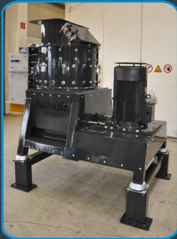
Bomatic ha instalado recientemente una **trituradora vertical** modelo **Rotacrex R750** de color negro para la trituración de estiércol con trozos de paja.
