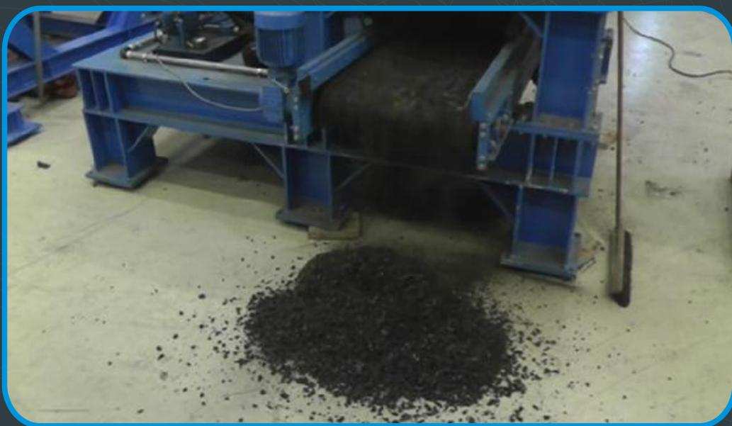
Los granuladores de Bomatic, están especializados en la granulación de neumáticos, residuos electrónicos, aluminio y plásticos. Concretamente el modelo que aparece en el video es el granulador **Bomatic UNICREX U1200** granulando neumático a un diámetro de aproximadamente **20mm**.
