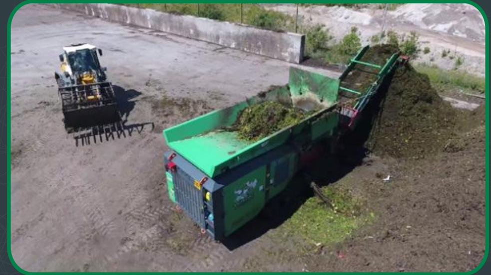
Tras un tiempo de uso con la trituradora **HAAS TYRON 2000 XL v.2.0** el cliente comentó que el triturador está triturando casi tres veces más que su anterior triturador de un solo eje y destacó de HAAS la característica de poder cambiar la velocidad y dirección de cada eje de forma independiente acorde al material que se procese. **Con solo pulsar un botón, la configuración de la trituradora se puede cambiar para satisfacer la variedad de formas de residuos verdes que trabaje.**
