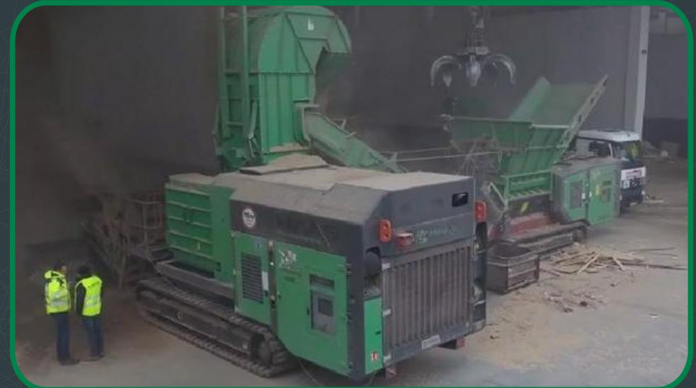
La **cinta de salida** es **pivotante +/- 30 grados** con una altura de descarga de hasta 3900 mm
