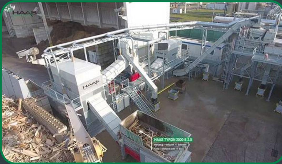
Esta completa planta de reciclaje para restos y residuos de madera industrial como palets, tableros, etc. tiene una producción aproximada de hasta 30 toneladas la hora y ha sido instalada en Colonia (Alemania).
