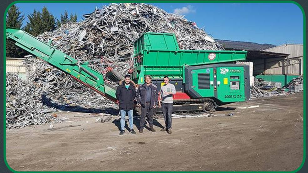
Los materiales están organizados por tipo de material y ubicados en distintas partes de la planta, **depende de lo que van a triturar el triturador HAAS TYRON 2000 XL v.2.0 se desplaza por diferentes zonas de la planta**, usando un **sistema de orugas calzadas con gomas** que permite su movilidad por casi todo tipo de terrenos, **esta movilidad puede ser controlada fácilmente mediante mando a distancia**.
