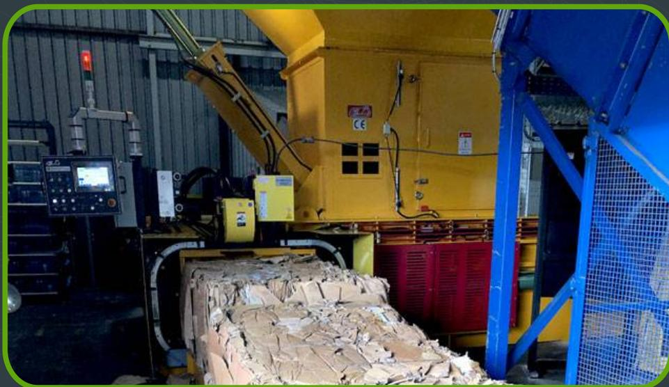
Whitham Mills considerado como uno de los grandes diseñadores y fabricantes de prensas embaladoras, ha obtenido un impresionante pedido de Leadec, este pedido consta principalmente de la prensa embaladora TWIN RAM GB1575TR junto con una renovación completa de su transportador y varias modificaciones, como un mayor tamaño de la tolva para garantizar una automatización más fluida.
