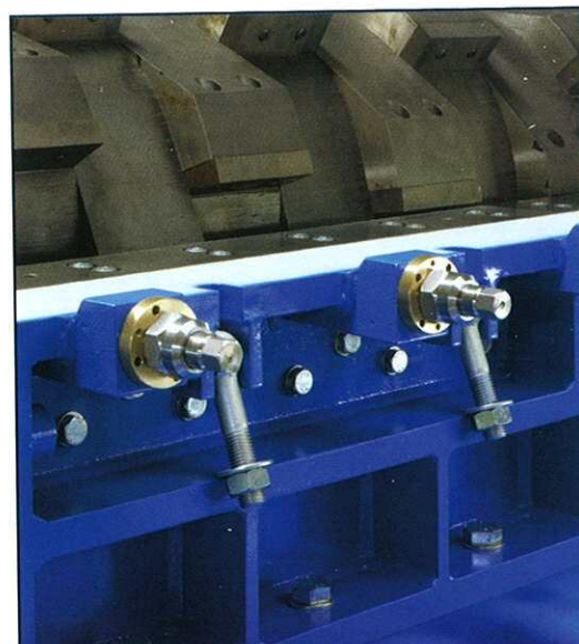
Posibilidad de ajuste de la ranura de corte desde fuera
