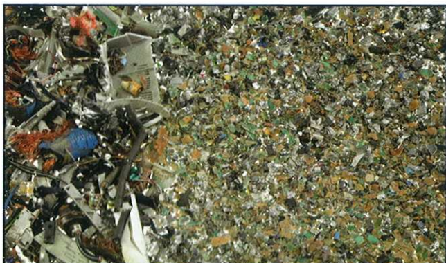
Granulado de residuos eléctricos y electrónicos
